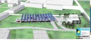
Réseau de chaleur alimenté par une centrale de production énergétique combinant des capteurs solaires haute température et une chaudière biomasse.
