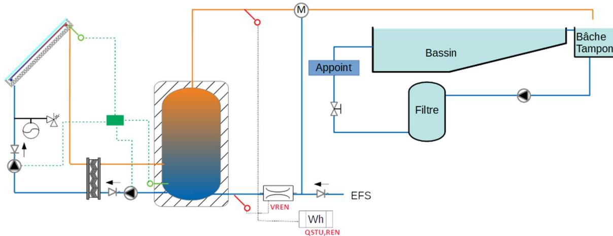
Les différents schémas de la schématique SOCOL [6] sont donc adaptés, avec une vigilance sur la température de distribution, qui doit être compatible avec la température du bassin et/ou la température admissible des composants techniques (matériau de la bâche tampon par exemple).
