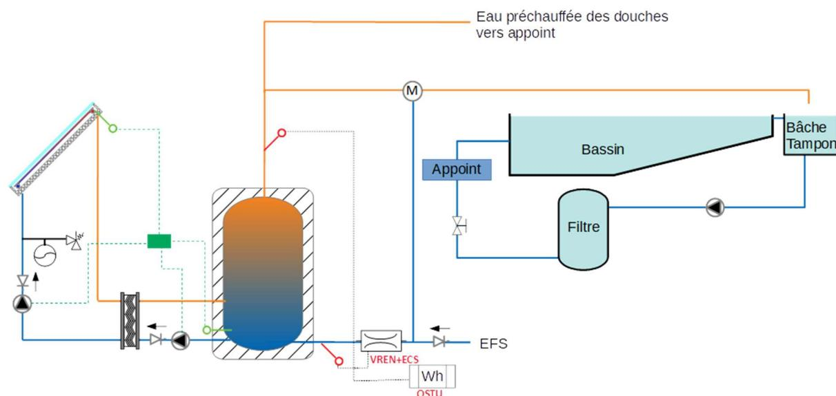
Les différents schémas de la schématique SOCOL [6] sont donc adaptés, avec une vigilance sur la température de distribution pour l'eau de renouvellement, qui doit être compatible avec la température du bassin et/ou la température admissible des composants techniques (matériau de la bâche tampon par exemple).
