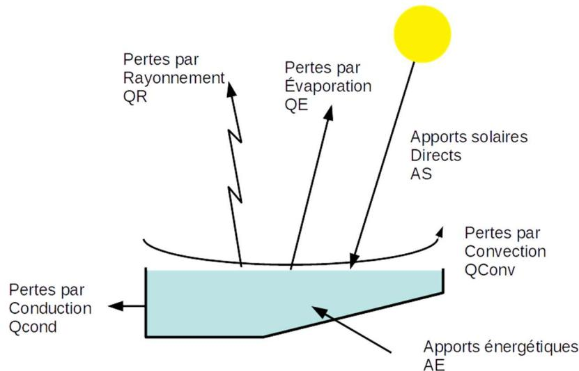
Figure 1 : Bilan thermique d'une piscine
