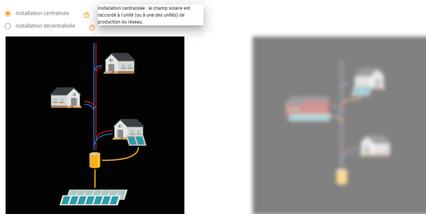
Figure 4. MODE D'INSTALLATION, CENTRALISEE OU DECENTRALISEE.
