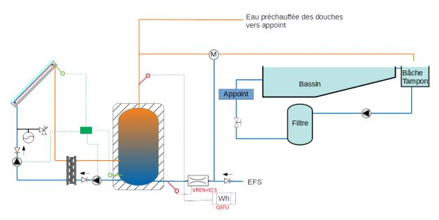
Les différents schémas de la schémathèque SOCOL [6] sont donc adaptés, avec une vigilance sur la température de distribution pour l'eau de renouvellement, qui doit être compatible avec la température du bassin et/ou la température admissible des composants techniques (matériau de la bâche tampon par exemple).
