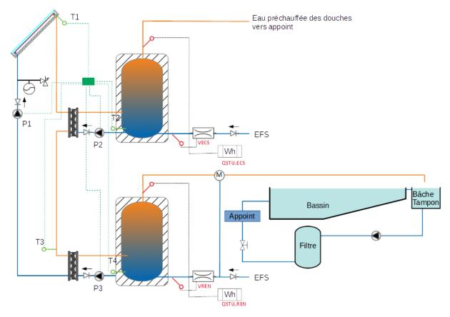
2.6.3 Mode de fonctionnement y compris pilotage de l'installation
