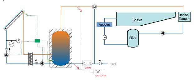
Les différents schémas de la schémathèque SOCOL [6] sont donc adaptés, avec une vigilance sur la température de distribution, qui doit être compatible avec la température du bassin et/ou la température admissible des composants techniques (matériau de la bâche tampon par exemple).
