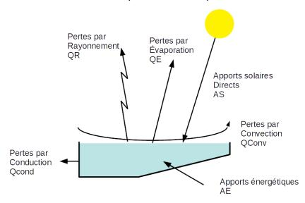
Figure 1 : Bilan thermique d'une piscine
